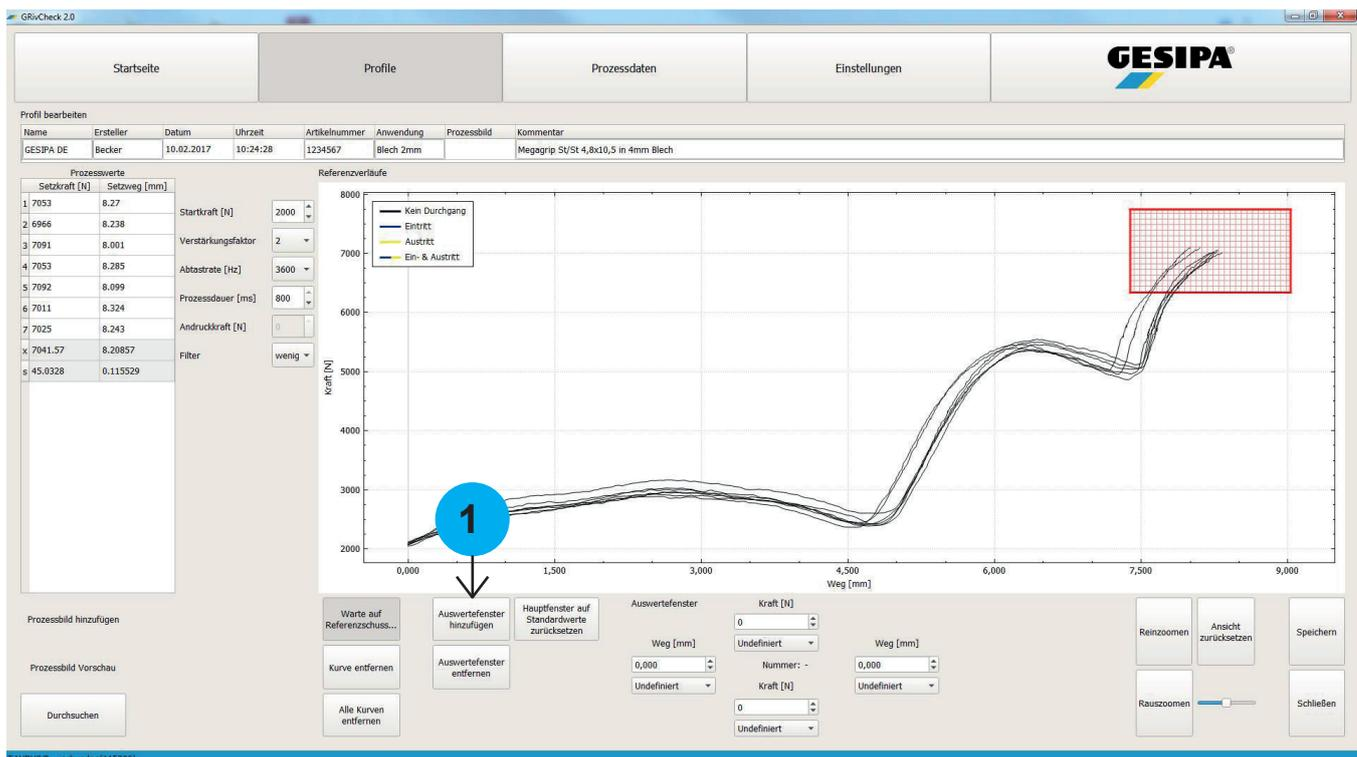
Das Auswertefenster muss definiert werden. Hierzu Auswertefenster auswählen und Größe bestimmen. Im unteren Menü (1) müssen die Fensterseiten definiert werden. Wenn das Fenster definiert wurde kann nun eine n.iO Vernietung durchgeführt werden (z.B. Bauteil vergessen, Niet nicht richtig in Bauteil eingeführt, Bauteil zuviel eingelegt usw.)
