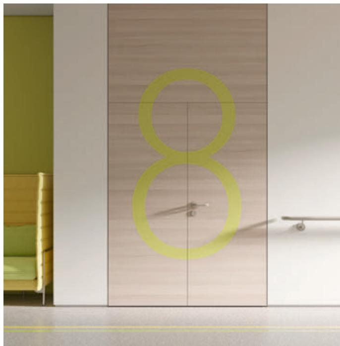
Les mains courantes HEWI pour les couloirs et les cages d'escalier ne servent pas seulement d'appui, mais forment également un système d'orientation visuel à travers le bâtiment. Ces produits sont disponibles en acier inoxydable classique et particulièrement robuste et en polyamide coloré. Les mains courantes doivent contraster avec l'arrière-plan pour que les personnes malvoyantes puissent les utiliser pour s'orienter.
