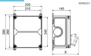
Standard cable entries pre-punched Top: 1xM12, 1xM20, 2xM32 oder 2xM40 Bottom:1xM12, 1xM20, 2xM32 oder 2xM40
