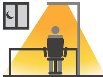
bei Änderungen im Bereich von 20° unter dem Tageslichtsensor, wird die Helligkeit angepasst
