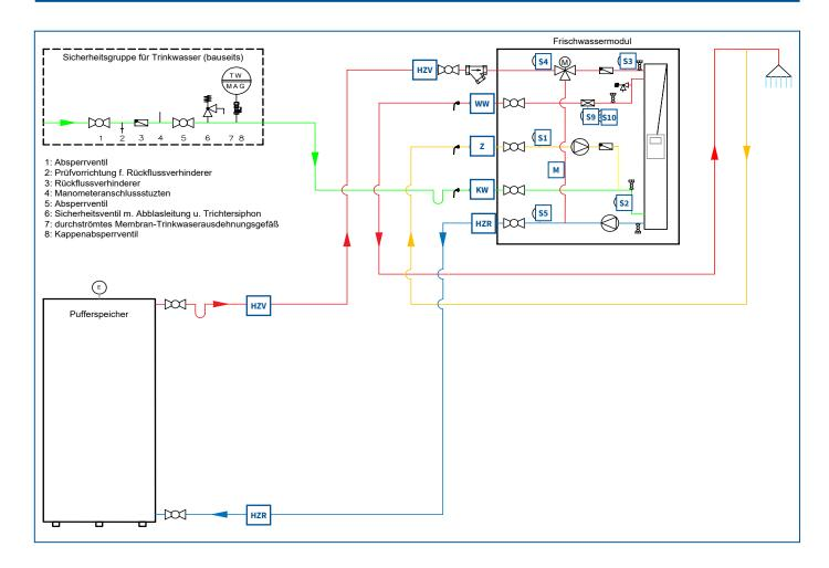
**Zirkulation** S1 **S2 Kaltwasser Primär Vorlauf S**3 **S4 Heizung Vorlauf S5** Primär Rücklauf / ZZR **S**6 Speicherladung Ein/Aus o. ZZR (optional) **Speicherladung Ein/Aus o. ZZR (optional) S7 S**8 Wärmeerzeugerumschaltung (optional) **S**9 Warmwassertemperatur **S10 Warmwasser Durchfluss**
