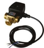
Zwei-Zonen-Rückschichtung zur bauseitigen Installation in den Heizungsrücklauf zum Pufferspeicher, um eine hohe thermische Durchmischung im Puffer zu verhindern. Die Steuerung erfolgt über den Frischwasserregler. Lieferumfang: 3-Wege-Zonenventil bzw. 3-Wege-Mischer und Stellmotor.
