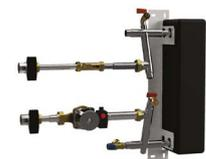
kombinierbar mit Wärmeerzeugern und geeignet für die direkte Einbindung in Nah- und Fernwärmenetze Betriebsdruck primär bis max. 16 bar, Betriebstemperatur primär bis max. 130 °C, bei Betriebstemperaturen > 110 °C ist ein Sicherheitstemperaturwächter zu installieren. Betriebsdruck sekundär bis max. 10 bar
