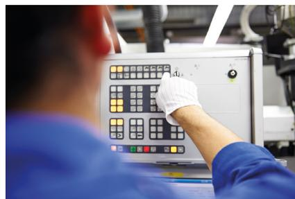
Über digitale Eingänge an der KIS.Box oder KIS.Light können Maschinendaten (mit Hilfe zusätzlicher Sensoren, wie beispielsweise Lichtschranken oder Abstandsmessern) erfasst werden. Die Daten sendet jedes der KIS-Produkte in einem gewissen zeitlichen Takt an den KIS.Manager, d.h. direkt in die Cloud. Hier laufen die Daten aller KIS-Devices zusammen.
