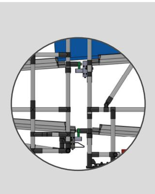
Der MC-SFS wird ausgelöst durch seitliches Heranfahren an das Regal. Nach dem Andocken wird der Riegel nach unten geschoben, die Behälter frei gegeben, die sich daraufhin selbstständig in Bewegung setzen.
