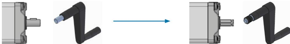
Die Pumpen und die Anbauteile wie Handkurbel und Motor werden in Zukunft mit einer anderen Adaption verbaut. Die Funktion und Abmessung der Komponenten sind identisch geblieben.
