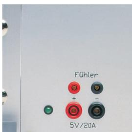
Durch die LED-Betriebsanzeige können sowohl Kurzschlüsse und Überströme als auch Überspannungsschutz- und Thermoschutzsituationen erkannt werden.
