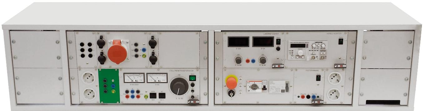
Das BeeWaTec Geräteprogramm ist als modulares System in 19"-Technik aufgebaut. Kleinere Geräte sind zum Teil in Kassettentechnik ausgeführt, große Geräte direkt im Baugruppenträger. Für große Geräte gilt damit einheitlich die Baubreite 19", die Bauhöhe beträgt 3HE oder 6HE. Die Geräte, die für diese Einbautart geeignet sind, sind der Gerätebeschreibung zu entnehmen.
