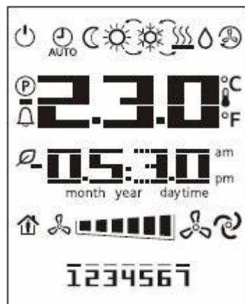
Abbildung 43: Übersicht über Anzeigen im Raumgerätedisplay
