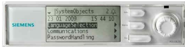
Abbildung 54: Integrierte HMI und Bedienelemente
