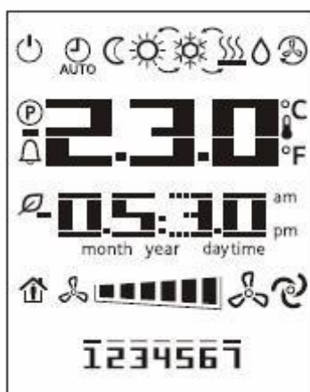
Abbildung 52: Übersicht über Anzeigen im Raumgerätedisplay
