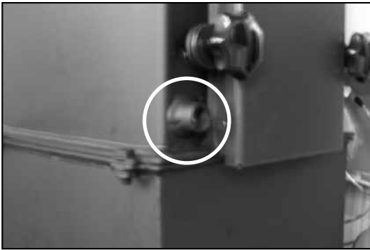
Abb. 06 Befüll- / Entleeranschluss BPH10, Anschluss 1/2 Zoll für KFE Hahn
