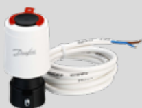
THERMISCHER STELLANTRIEB FÜR HEIZKREISVERTEILER CUC - mit Stellungsanzeige, ohne Handverstellung. - Anschluss: M30 x 1,5 AG - Kabellänge: 1,2 m - Elektroanschluss: 230 V - Leistungsaufnahme: 2 W
