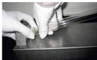
1. Ievietojiet UVC lampu aptverē
