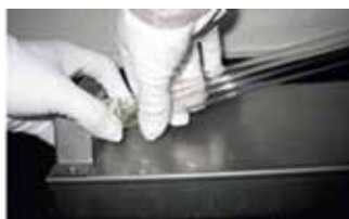
1. Introducir el tubo de luz UVC en el portalámparas
