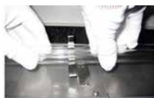
2. Ωθήστε τον λαμπτήρα UVC στον μπροστινό βραχίονα στήριξης
