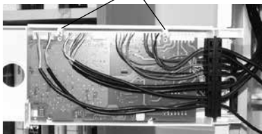
Rastnasen zur Fixierung der Regelungs-platine
