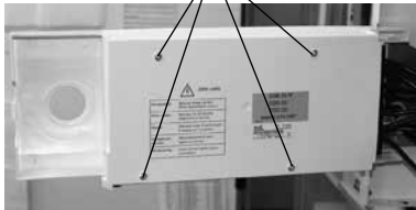
Rastnasen zur Fixierung der Regelungs-platine
