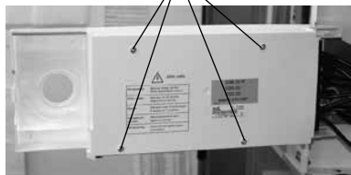
Arreteernezus ter bevestiging van de regelingsplatine
