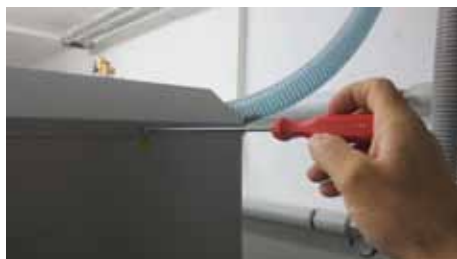
Abb. 49 Anlagendeckel: links und rechts mit der Verklei- dung verschrauben
