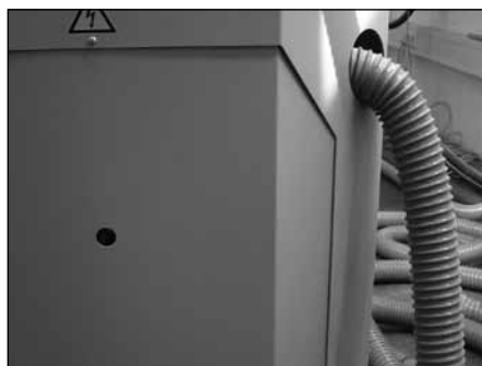
Abb. 42 Durchführung des Rückluftschlauches in der Mitte des Behälters
