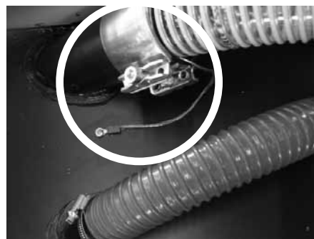
Abb. 44 Spannbride in montiertem Zustand mit Erdung (durch die sich im Förder- schlauch befindende Kupferlitze).
