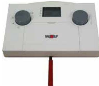
Demontage des AWT vom Sockel mittels Schraubendreher
