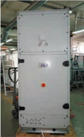
Kabeldurchführung für bauseitige Kabel
