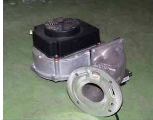
Bild: Sichtkontrolle Rückstromverhinderer
