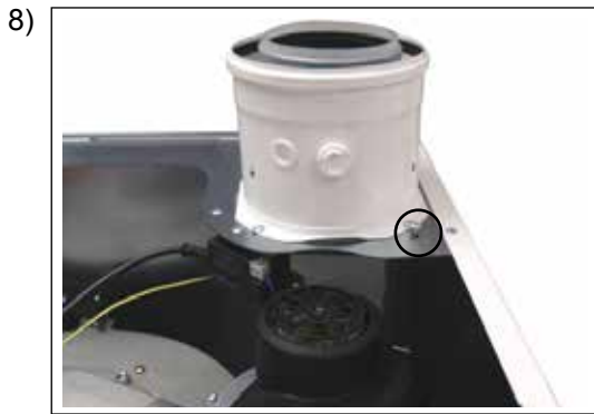
Nach Abnahme des oberen Verkleidungsdeckels Blechschraube Arretierung Luft- / Abgasrohr lösen.
