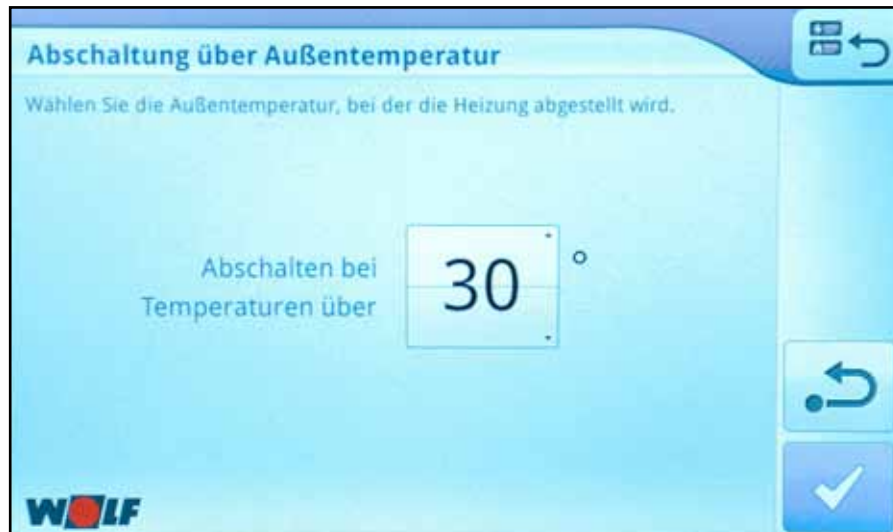
Bild 16: Abschaltung über Außentemperatur
