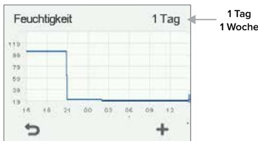
Statistik über die relative Luftfeuchtigkeit für die vergangenen 24 Stunden. Sie können die Grafik für eine Woche oder für einen einzigen Tag anzeigen.
