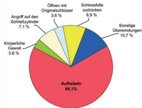
**Bild 5** Wege ins Haus – Täter setzen auf Körperkraft und Hebelwirkung
