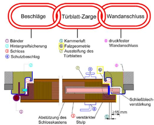
**Bild 3** Sicherheitskette einbruchhemmender Türen
