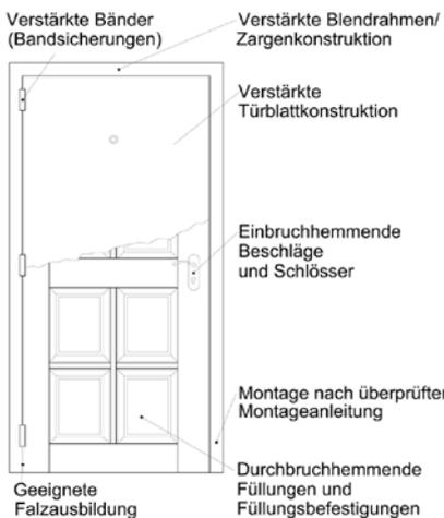
**Bild 2** Konstruktionsgrundsätze einbruchhemmender Türen
