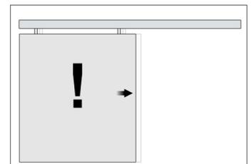
Die Lernfahrt wird dann eingeleitet, indem einer der beiden Taster kurz betätigt wird. Der Flügel verfährt langsam, bis dieser gegen die Endlage stößt und fährt anschließend in die andere Richtung, bis dieser auch dort gegen die Endlage stößt. Damit ist die Lernfahrt abgeschlossen.
