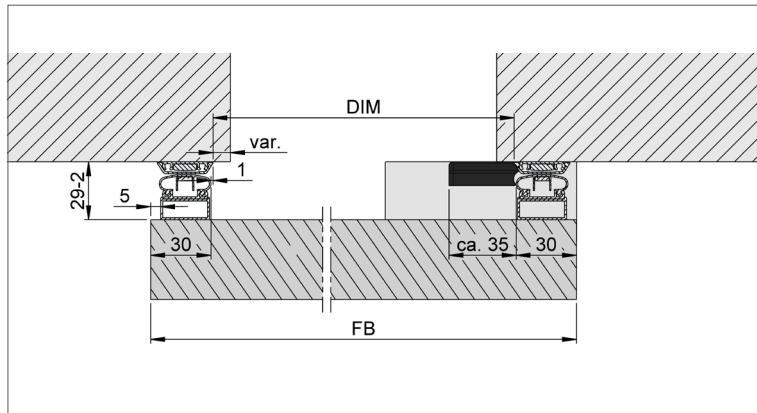
**Dichtungsinnenmaß / Sealing inner dimension**
