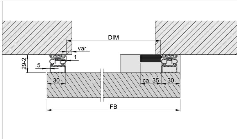
**Dichtungsinnenmaß / Sealing inner dimension**
