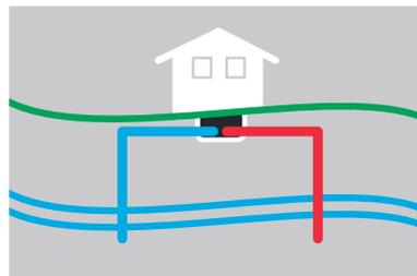
Die Grundwasser-Wärmepumpe zählt mit maximal 6,4 JAZ zu den effizientesten Wärmepumpen und nutzt für ihren Betrieb das vorhandene Grundwasser. Dafür benötigt die Grundwasser-Wärmepumpe grundsätzlich zwei Brunnen. Weitere Voraussetzung ist ein Grundwasser Vorkommen mit einem geringen Eisen- und Mangan-Gehalt, da sonst eine Verstopfung des Systems droht.
