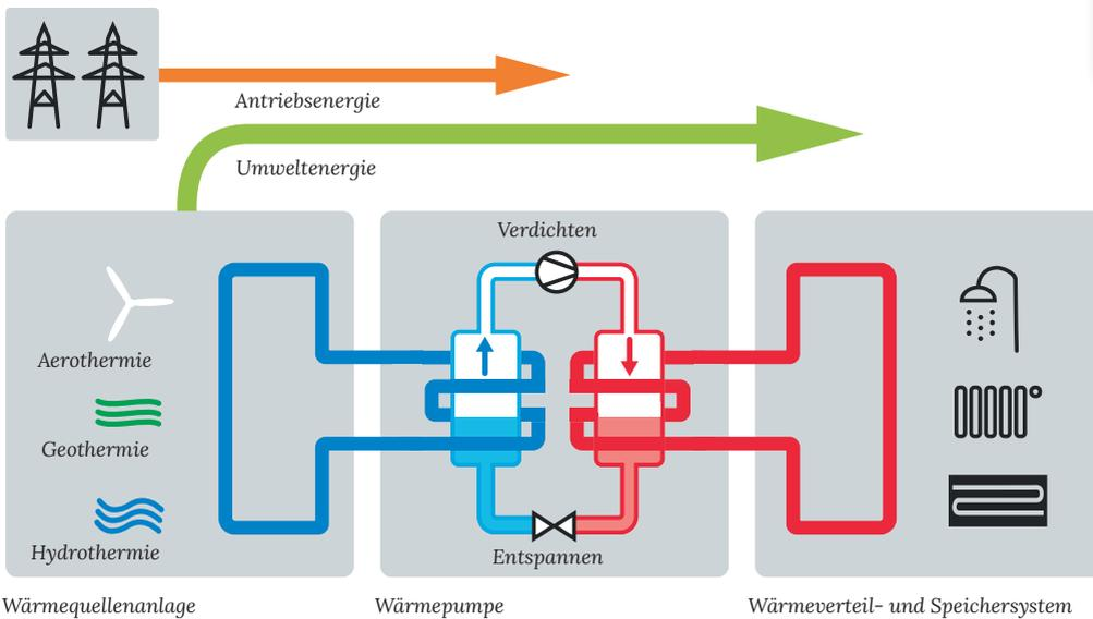
Funktionsprinzip einer Wärmepumpe: der Weg von der Wärmequelle bis ins Haus
