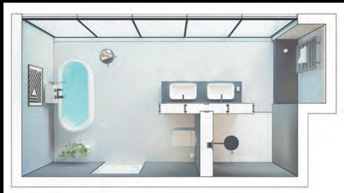
Mit den vorgefertigten „VISION T“- Wandelementen von Schedel, entstehen in kurzer Zeit drei separate Bereiche im Badezimmer. Duschplatz, WC-Bereich und ein Platz für einen Waschtisch. Die Hartschaum-Elemente aus EPS sind bereits werkseitig abgedichtet und können direkt verflieset werden. Vorbereitete Installationsschächte erleichtern die Montage. Ein schneller und unkomplizierter Ablauf dank den Systemlösungen von SCHEDEL!
