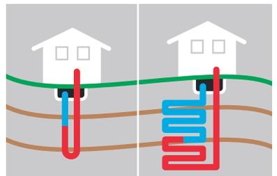
Eine Erdwärmepumpe erzielt maximal 5,2 JAZ und erfordert ein Bohrloch von bis zu 100 m Tiefe. Die darin montierte Sonde führt das zirkulierende Kältemittel. Eine Alternative dazu bieten Erdwärmekollektoren. Diese werden in einer Tiefe von zwei Metern eingebracht und auf Flächen von 40 m<sup>2</sup> pro Kilowatt verteilt. Neben dem dafür notwendigen Grundstück sind damit umfassendere Erdarbeiten für eine den Energiebedarf abdeckende Installation einzuplanen.
