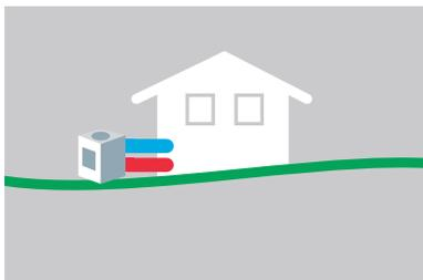
Die einfachste Installation ermöglicht eine Luft-Wasser-Wärmepumpe, da diese über nur ein Innengerät sowie ein Außengerät für die Außenluft Einspeisung verfügt. Neue Systeme erhitzen das Brauchwasser auf bis zu 55 °C und eignen sich so ebenfalls für Sanierungsvorhaben. Für eine optimale Effizienz ist die richtige Auslegung auf das Gebäude entscheidend. Der Richtwert liegt bei maximal 4,7 JAZ (Jahresarbeitszahl), die Wärmepumpe sollte mindestens einen Wert von 3,5 COP erzielen.
