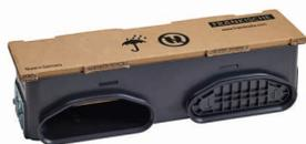
Boîte manchette en PS pour le raccordement d'un conduit profi-air tunnel avec un élément de connexion et d'étanchéité profi-air tunnel. 2 conduits raccordables max. Peut être utilisé pour l'air soufflé et l'air vicié. Fixation par équerre. Adaptée à l'installation sur les murs, les planchers et les plafonds. Dispositif de protection contre les éclaboussures et contre le piétinement. La boîte manchette tunnel est le support de base pour le cadre de montage plus starline.
