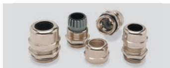
HT MS-EP Mosiądz IP 68, 5 bar, temp. -40°C/+100°C, koszyk – stal
