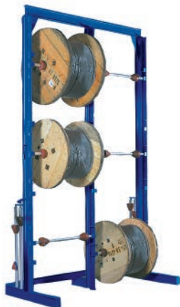
LAGBOI S – rozwiązanie ramowego stojaka dla szpul i bębnow od średnicy 400mm do 1000mm. Wysokość regału 3m. Istnieje możliwość rozbudowy regału o układ jezdny – do zastosowania na gładkich, poziomych płaszczyznach.
