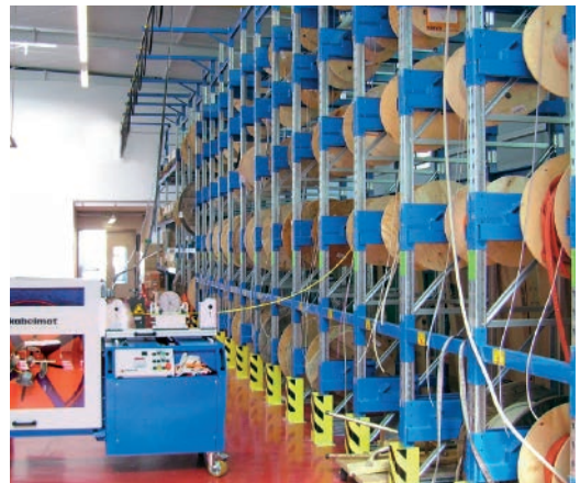
SYSTEM LAGROL /ABROL – rozwiązania idealne dla Centrum logistycznego sieci hurtowni, zakładów produkcyjnych. HELUKABEL Polska dostarczył już kilkanaście takich rozwiązań do swoich Partnerów na terenie całej Polski.
