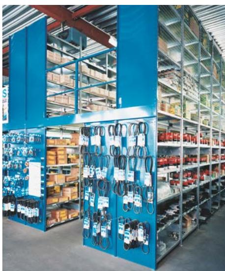
*2-geschossige Fachbodenanlage für die Kleinteilelagerung im Kfz-Bereich*
