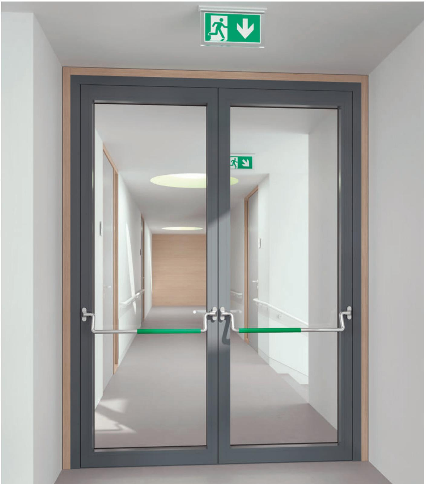
HEWI Panikstangen sind mit minimalem Kraftaufwand intuitiv zu bedienen und erfüllen damit die Anforderungen der DIN EN 1125 für Panikverschlüsse. Durch den aufgedoppelten Griffbereich aus farbigem Polyamid wird die Handhabung visualisiert und auch taktil erfassbar.
