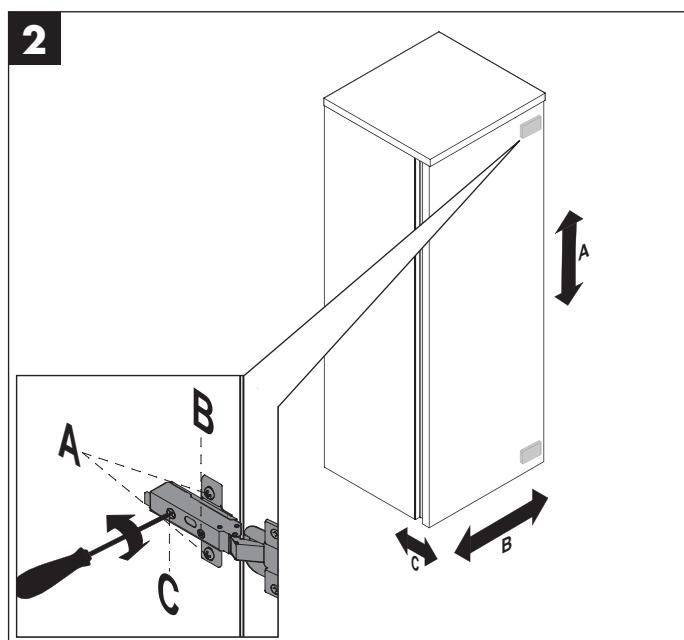
**DÄMPFERVERSTELLUNG** ADJUSTMENT OF DAMPER // RÉGLAGE DE L'ARMORISSEUR // DEMPER VERSTELLUNG // REGOLAZIONE DE L'ARMORTIZZATORE // РЕГУЛЯЦИЯ АМОРТИЗАТОРА
