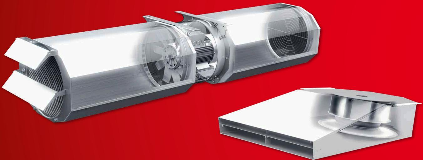
Axiale und radiale Impulsventilatoren werden in Parkgaragen zur täglichen Be- und Entlüftung eingesetzt und stellen im Brandfall die Rauchabführung zur Unterstützung des Feuerwehrangegriffs sicher. Aufgrund des erzeugten Luftstrahls üben sie eine Impulswirkung auf die Luft aus. Somit kommt es zu einer Luftbewegung in der jeweiligen Strahlrichtung hin
