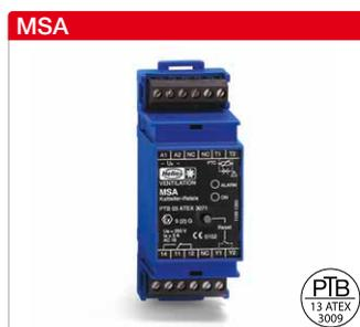
Bei Erreichen der Nenn-Ansprechtemperatur eines Kaltleiters fällt das eingebaute Relais ab. Störung wird durch eingebaute Leuchtdiode angezeigt. Wiederinbetriebnahme durch Drücken der Taste „Reset“ oder über extern anschließbaren Schalter. Kunststoffgehäuse für Schaltschrankinstallation auf Tragschiene nach DIN EN 60715.
