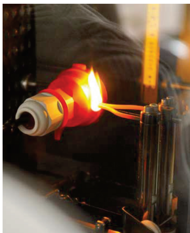
Ensaio do fio incandescente
