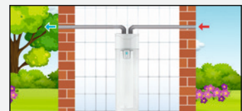
Zu- und Abluftfunktion nach außen über separaten Luftkanalanschluss.
