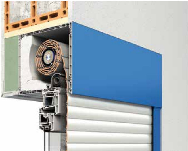
Kunststoff-Aufsatzelement KARO Innenliegende Revision, mit Aluminium-Außenblende (optional)
