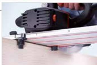
Sulla parte inferiore della guida sono presenti le battute che permettono di impostare l'angolazione secondo la scala. Al termine del passaggio
