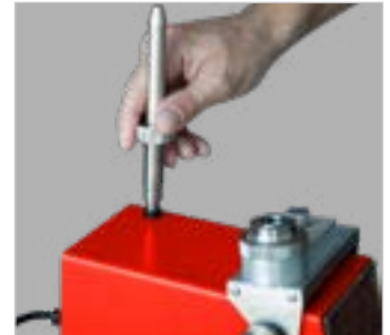
Anschlag zur Einstellung der richtigen Schleiflänge im Gerät integriert
