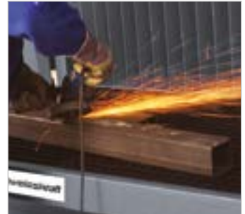
Hoher Schleifstauberfassungsgrad aufgrund der Rückwanderfassung
