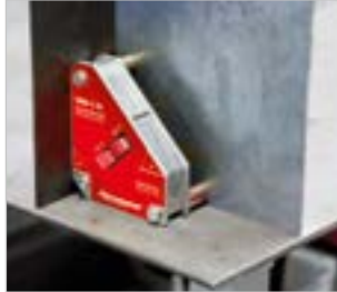
zum Halten von metallischen Werkstücken im 45° oder 90°-Winkel
