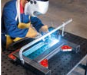
zum Halten von metallischen Werkstücken im 45° oder 90°-Winkel
