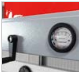
Filterüberwachung über Manometer
