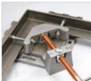
▶ mit Vorrichtung zur besseren Klemmung von Profilen
