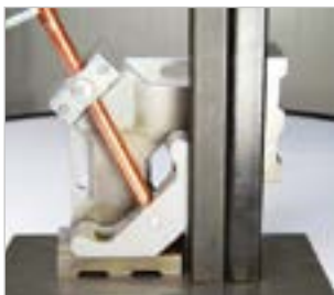
▶ gefräste Seiten zum Aufrecht-Stellen der Metallwinkelspanner
