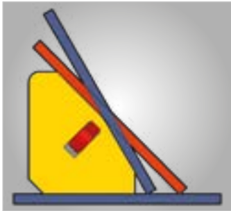
• Zum Halten von metallischen Werkstücken im 30°- oder 60°-Winkel
