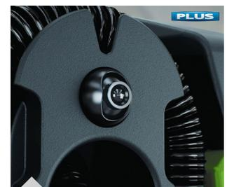
Hinterere Kamera zur Kontrolle der Reinigungsleistung
