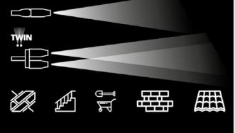
Modus mit 2 Pumpen, dadurch höherer Arbeitsdruck und Wasserfluss für starke Verschmutzungen
