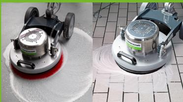
Grundreinigung mit Wasser von Hart- und Vinylböden
