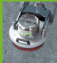
Entwachsen und Aufpolieren von Vinylböden
