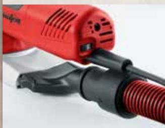
El canal de extracción integrado en la placa base garantiza una excelente absorción directamente en la hoja de sierra gracias al principio Venturi. La grieta se expulsa por un lado y se aspira por el otro. Esto mantiene la grieta libre de virutas y siempre se puede ver incluso sin una aspiradora conectada.
