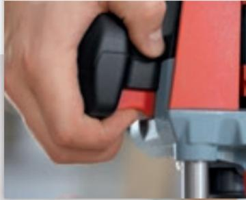
La profundidad de fresado está fijada de forma permanente. Al pulsar la tecla Permafix, se suelta la sujeción y puedes ajustar cómodamente la profundidad de fresado.
