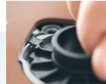
Al colocarlo, el anillo copiador se centra automáticamente con el alojamiento calibrado de fábrica. Esto elimina el largo y costoso proceso de alineación.
