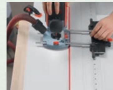
En combinación con el adaptador de fresadora superior LO-FA y la guía F-LR, puedes taladrar filas de agujeros con seguridad y precisión. Para avanzar rápidamente en tu trabajo, basta con desactivar la sujeción Permafis.
