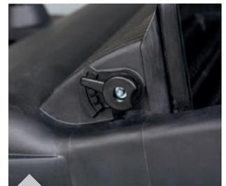
Einfache und werkzeuglose Höhenverstellung der Kehrwalze
