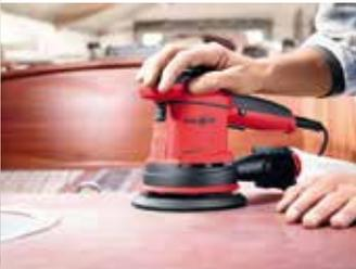
Für Feinschliff oder einen Lackzwischen Schliff eignet sich besonders der EVA 150 E/3 mit seinem Schwinghub von 3 mm.
