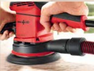
Viele Absaugkanäle und ein effektives Absauggerät sichern zusammen eine optimale Absaugung. Selbst ohne Fremdabsaugung ist der EVA 150 E dank seiner leistungsstarken Absaugturbine extrem effektiv und staubarm.
