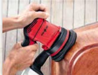
Mit der niveauegleichenden Softauflage lassen sich beste Arbeitsergebnisse an konkaven und konvexen Flächen erzielen. Der Schaumstoffpad gleicht Unebenheiten aus und sorgt für gleichmäßige Schleifergebnisse.
