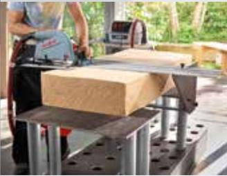
Mit der DSS 300 cc lassen sich auch flexible Dämmstoffe, zum Beispiel für die Dämmung im Gefach, schnell und präzise bearbeiten.
