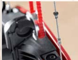
Die einzigartigen Schneidglieder des Sägeseils wurden speziell so konstruiert, dass sie in alle Richtungen schneiden können. Das Spezialwerkzeug ist jeweils mit 23 Säge- und Antriebsgliedern ausgestattet.
