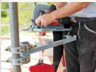
Mit der Maschinenhalterung S 200-MH lässt sich die DSS 300 cc entweder am Volumensauger oder - mit Hilfe von Gerüstschellen - auch beim Einsatz auf dem Gerüst jederzeit sicher ablegen.
