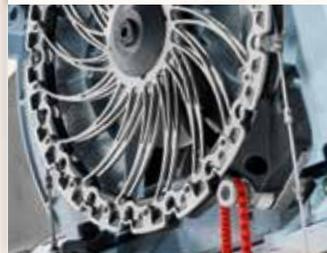
Die Seilumlenkrolle besitzt eine zweigeteilte Aufnahme für die Säge- und Antriebsglieder. Zudem verhindern die Räumern oben und unten am Rad Spanablagerungen und sorgen für eine exakte Seilführung.
