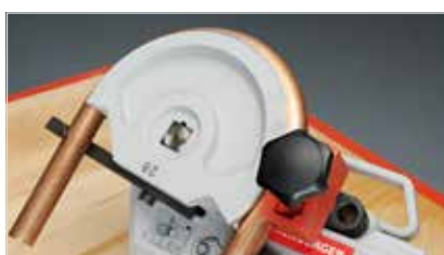
Hormas de aluminio forjado con escala del ángulo de curvado.
