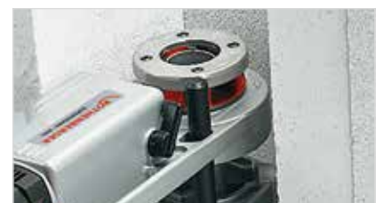
Permite roscar en áreas de difícil acceso y cercanas a la pared.
