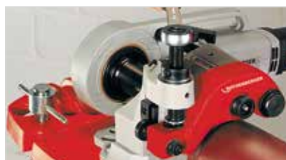
Compatible con el accesorio de ranurado ROGROOVER 1"-6"
