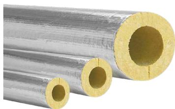
Die nicht brennbare Steinwolle-Rohrschale, geschützt durch eine äußere Beschichtung aus verstärktem Aluminium mit hoher Wasserdampfbeständigkeit. **A24 Typ ROCK ALU** wird für die Wärmedämmung von Rohren empfohlen, die heiße Flüssigkeiten in Gebäuden im Wohn-, Dienstleistungs- und Industriebereich fördern.
