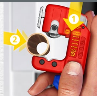
... still inn med skalaen og klikk på røret med det fjærbelastede skjærehjulet
