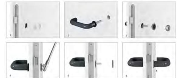
1. Bei gefälzten Türen Montagekeile zwischen Schloss und Schlosstaschenfräsung einsetzen.
