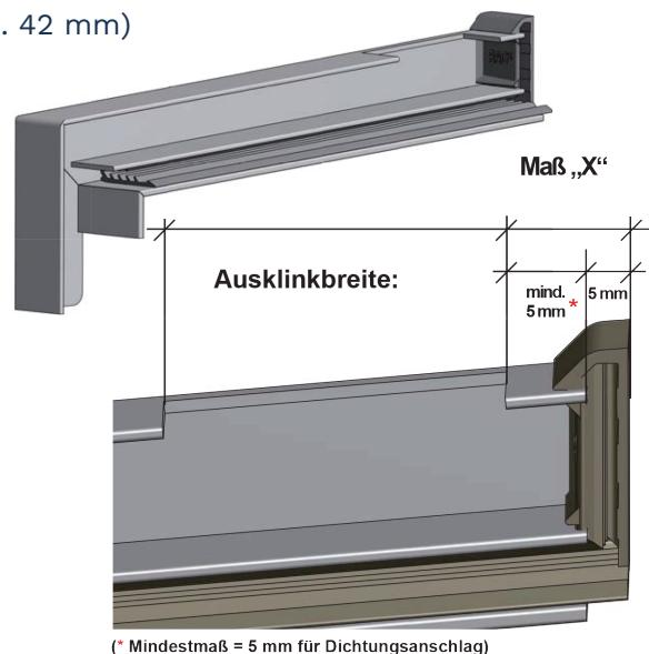
Die Rolladenführungsschiene muss innerhalb der seitlichen Aufkantung und soll max. 8 mm vor der Oberkante der Fensterbank enden. Ein direktes Aufstehen der Rolladenführungsschiene auf der Fensterbank ist nicht zulässig.
