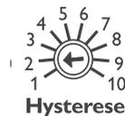
Zur optimalen Anpassung der Hysterese an bestehende Solar- und Heizungsanlagen kann diese an einem Potentiometer in dem Boden des Gehäuseoberteils von 1 ... 10 K eingestellt werden. Auf diesem Wege kann die Regelung optimal auf das individuelle System abgestimmt werden. (Achtung: Hysterese muß stets kleiner als  $\Delta T$  eingestellt werden !)
