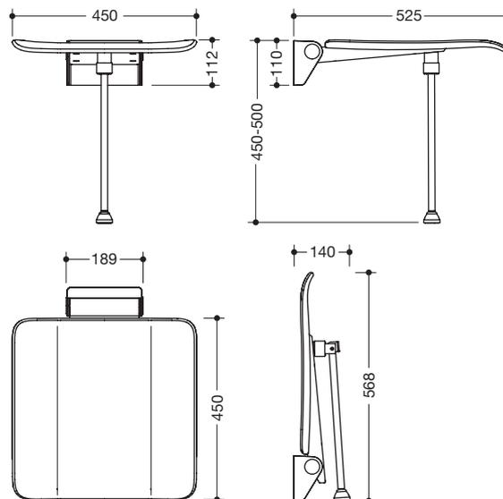
**Siège relevable HEWI avec appui au sol**
